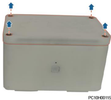
图7-10 拆除传感器盖子
